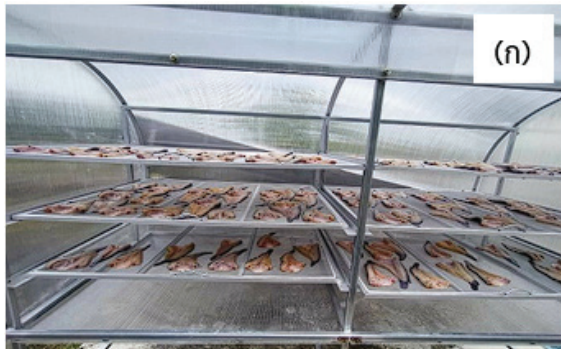
ภาพ 3 (ก) ผลิตภัณฑ์ปลาตากแดดเดียวในตู้อบพลังงานแสงอาทิตย์ และ (ข) ตู้อบพลังงานแสงอาทิตย์ “รุ่นหลังเต่า”
