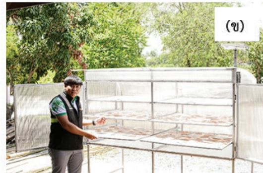
ภาพ 3 (ก) ผลิตภัณฑ์ปลาตากแดดเดียวในตู้อบพลังงานแสงอาทิตย์ และ (ข) ตู้อบพลังงานแสงอาทิตย์ “รุ่นหลังเต่า”
