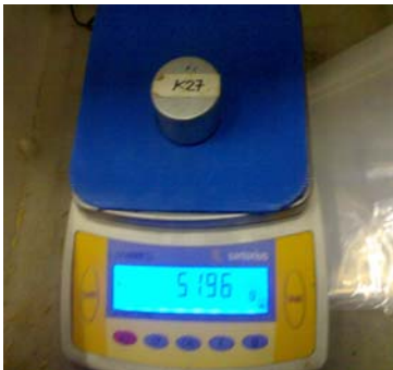
ภาพที่ จ.5 เครื่องชั่ง ซึ่งสามารถชั่งได้สูงสุด 2,100 g
