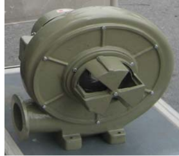
ภาพที่ จ.2 พัดลม (blower) แบบใบพัดโค้งหลัง
