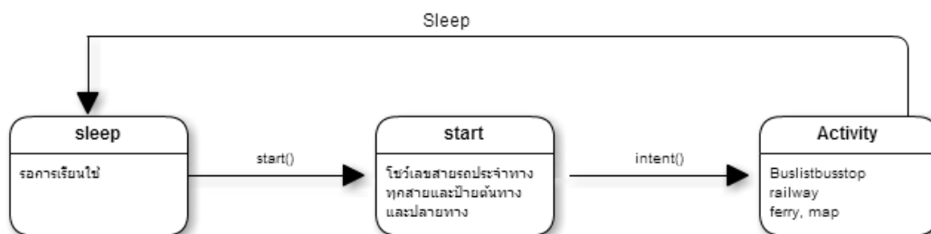
รูปที่ 3.21 state diagram ของ class bus (Android User)
