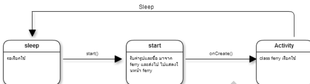
รูปที่ 3.31 state diagram ของ class CustomListAdapterferry (Android User)
