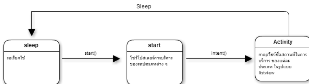
รูปที่ 3.34 state diagram ของ class mapbus_busstop (Android User)
