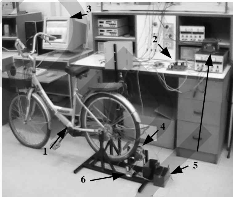
รูปที่ 3.2 โครงสร้างทางกลเมื่อทำการติดตั้งอุปกรณ์ต่างๆ เข้ากับฐานโครงเหล็ก
