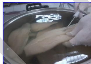
ภาพที่ 3 การแซ่-ฉีด สารละลาย Geosmin มาตรฐาน เข้าชิ้นเนื้อปลาสวายโมงแล้ (ควบคุมอุณหภูมิชิ้นปลา ไม่เกิน 15^{\circ}\text{C} )
